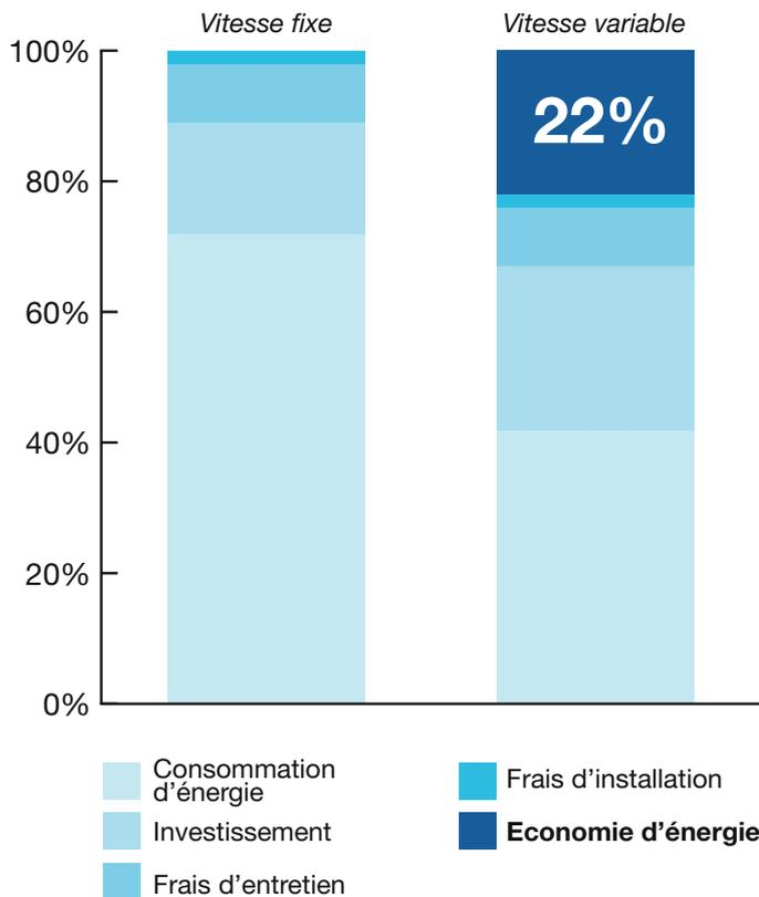
Pour adapter sa production d'air, votre compresseur utilise fréquemment de coûteuses périodes de marche à vide. Un compresseur à vitesse variable réduit ou augmente la vitesse du moteur principal pour suivre avec précision le profil de votre consommation d'air comprimé. Vous réalisez ainsi une économie considérable sur votre facture d'énergie.
